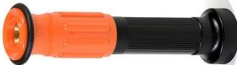
Lancia a tre effetti DN45 in materiale plastico, dotata di meccanismo di commutazione a rotazione. Filettatura UNI 45.
