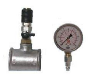
Strumento per la misurazione della pressione dinamica e/o statica sui sistemi CE come richiesto dalla norma UNI10779.
