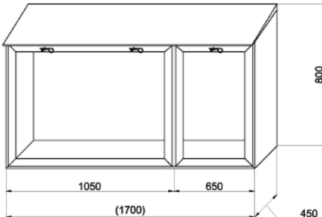
Cassetta da esterni per contenimento gruppi motopompa in lamiera zincata non verniciata con tettuccio spiovente. Telaio porta vetro in alluminio anodizzato.
